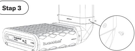
Instale los tornillos en el tubo (2x)
