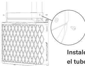
Instale los tornillos en el tubo (2x)
